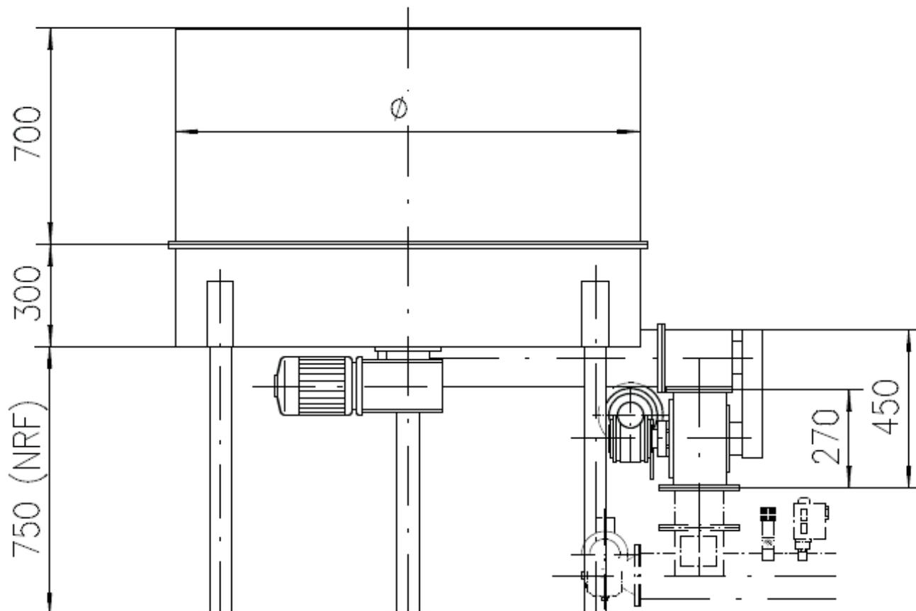
■ Die robusten Behälter Typ VBR sind mit Rührwerk und Antriebseinheit ausgestattet. Die Beschickung von bis zu zwei automatischen Feuerungen ist je nach Anforderung möglich.
