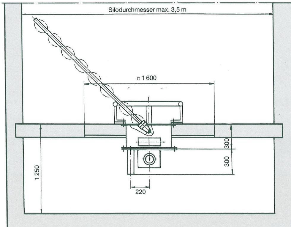
■ Die Siloaustragung S 100 ist für Holzspänebrennstoffe einschließlich Hackschnitzel bis 20 mm Schnittlänge geeignet. Die Schnitzeldicke soll 5 mm nicht überschreiten.
